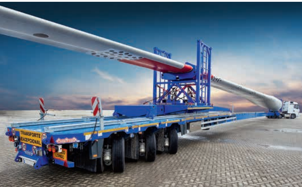
De Super Wing Carrier voor het transport van gigantische 65 meter lange windmolenwieken.
